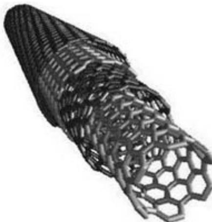
Рис. 2 Многослойные углеродные нанотрубки [4]
